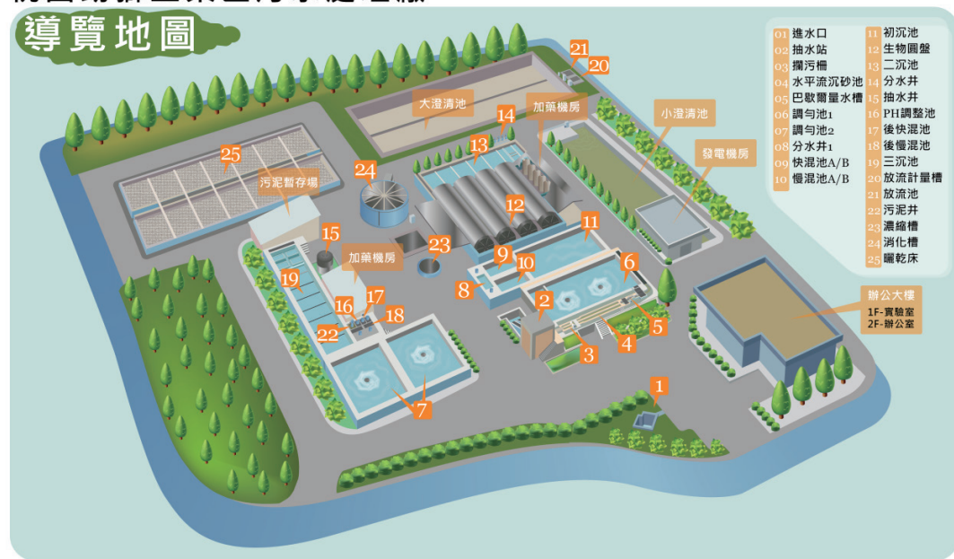
圖1 汙水處理廠平面配置圖
